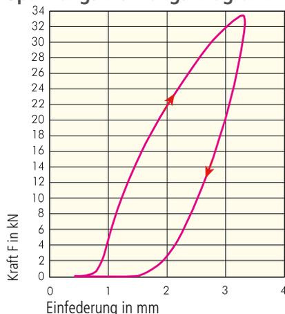
Das Diagramm zeigt den Spannungs-Dehnungs-Verlauf der Elastomerfeder bzw. das Verhalten des Podestlager-Systems ISO-MODUL-28-45 bei Belastung und Entlastung unter der Kraft F.
