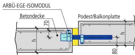
**Durchbiegung Betonplatte:** Die zu erwartende Durchbiegung der Betonplatte und des Treppenlaufs muss durch den zuständigen Ingenieur berechnet und geprüft werden.
