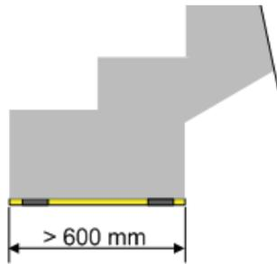
Wird das Mass von 600 mm bei der Treppentiefe überschritten, wird das Treppenlager mit 4 Punkten produziert. Dieses wird eingesetzt bis zu einer Tiefe von 1200 mm. Sobald die Tiefe von 1200 mm überstiegen wird, müssen zwingend die Pläne für die Berechnung mitgesendet werden. Alternativ werden ab 1000 mm auch Vollflächenlager eingesetzt.
