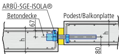
**Durchbiegung Betonplatte:** Die zu erwartende Durchbiegung der Betonplatte und des Treppenlaufs muss durch den zuständigen Ingenieur berechnet und geprüft werden.
