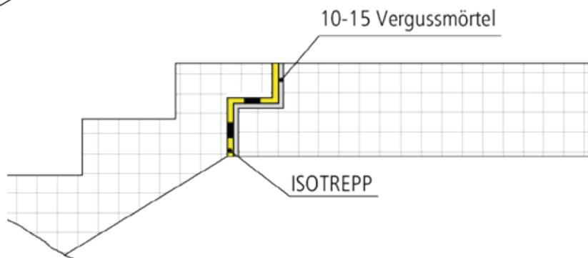
Bei Ausführung mit vorgefertigten Beton-Elementen ist eine Fugenöffnung von 10 - 15 mm zwischen dem ISOTREPP® Treppenlager und der Auflagerabwicklung auf der Podestseite einzuplanen. Die Fuge wird nach der Montage des Treppenlauf-Elementes mit Vergussmörtel ausgegossen. Dieser Arbeitsschritt ist in der Einbauanleitung dokumentiert.
