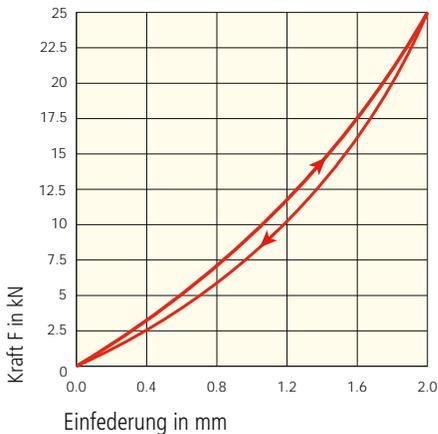
Das Diagramm zeigt den Spannungs-Dehnungs-Verlauf der Elastomerfeder im Schallschutzgehäuse bzw. das Verhalten des ISOSCALA®-28-60 Podestlager-Systems bei Belastung und Entlastung unter der Kraft F.
