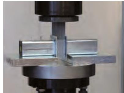
Druckvorrichtung für die Stufenbelastungsversuche an der EMPA. Damit wurden am Schallschutzgehäuse die statische Einfederung unter Dauerlast sowie die dynamische Steifigkeit der Elastomerfeder ermittelt.
