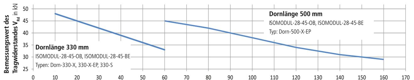
$e$ : Für die Bemessung massgebende Fugenöffnung
