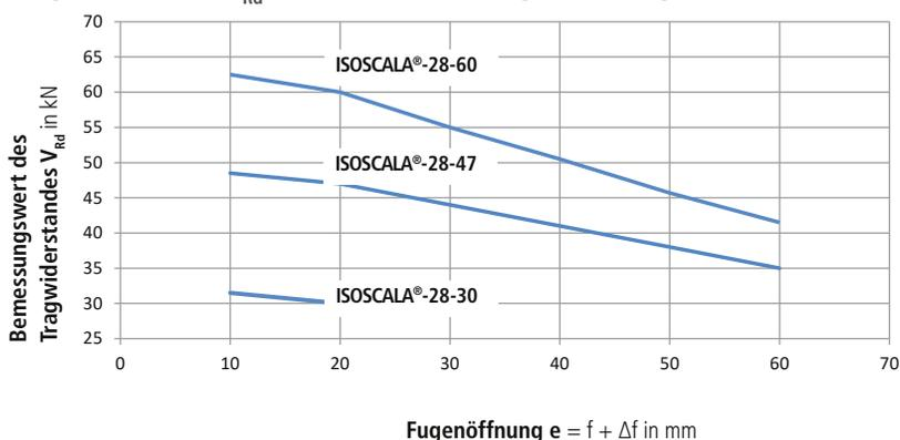
Die Tragwiderstands-Werte wurden mittels Podestplatten mit einer Dicke von 200 mm ermittelt.
