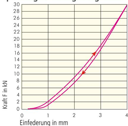
Das Diagramm zeigt den Spannungs-Dehnungs-Verlauf der Elastomerfeder im Schallschutzgehäuse bzw. das Verhalten des ISOLA®-35-45 Podestlager-Systems bei Belastung und Entlastung unter der Kraft F.
