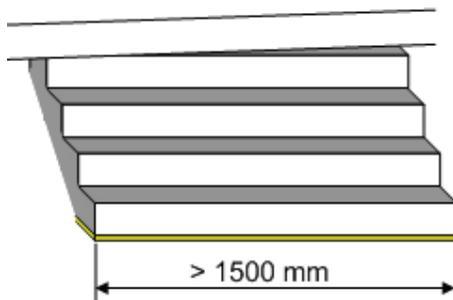
Übersteigt die Treppenlaufbreite das Mass von 1500 mm, werden 2 Treppenlager produziert.
