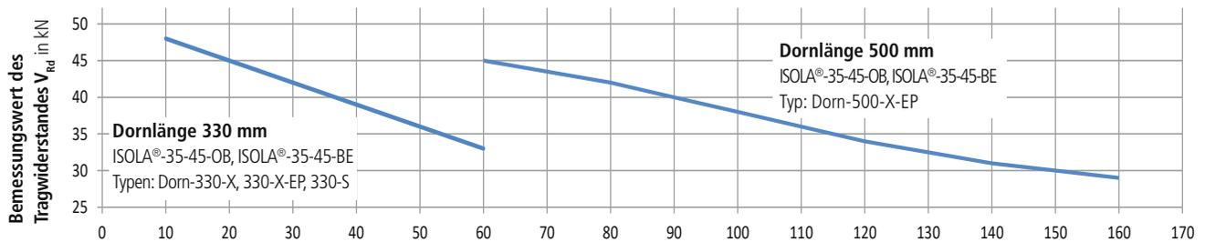
e: Für die Bemessung massgebende Fugenöffnung
