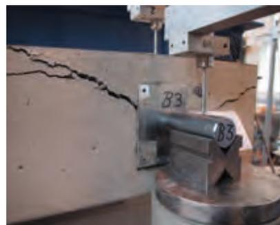
Die Querkraft wurde erhöht bis zum Bruch des Podestes. Die Grösse dieser Kraft wurde aufgezeichnet und die eingetretenen Verformungen am Querkraftdorn und Betonpodest gemessen. Anhand dieser Werte kann der Tragwiderstand des Systems (Podestlager mit Podest) präzise bestimmt werden.
