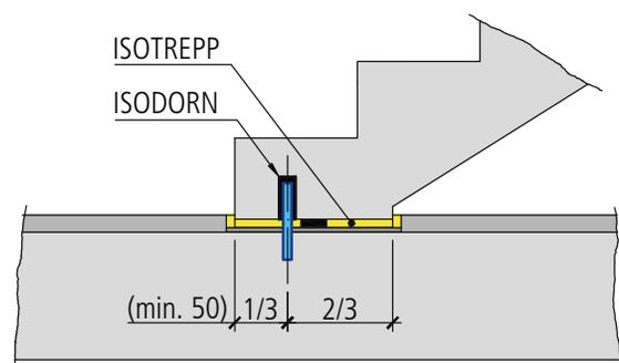
Die Sicherungsdorne ISODORN-A, ISODORN-B und der Sicherungswinkel ISOTRESI werden eingesetzt zur Horizontalsicherung mit gleichzeitiger Schalldämmung von elastisch gelagerten Treppenläufen auf ISOTREPP®-Treppenlager mit F-Form.
