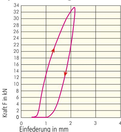
Das Diagramm zeigt den Spannungs-Dehnungs-Verlauf der Elastomerfeder im Schallschutzgehäuse bzw. das Verhalten des ISOTRON-28-50 Podestlager-Systems bei Belastung und Entlastung unter der Kraft F.
